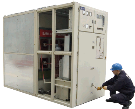
⑦ Hareket kolunu saat yönünde, servis pozisyonu lambası yana kadar çevirerek kesiciyi test pozisyonundan servis pozisyonuna alınız
